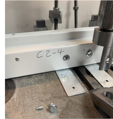
Essai de traction sur une vis montée sur structure métallique
