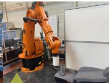
Essai coup de genou avec Robot KUKA
