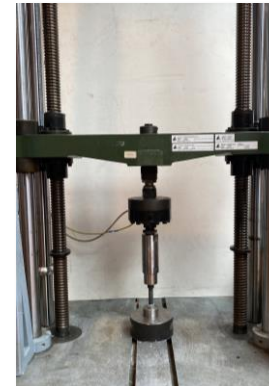
Essai de traction sur une vis montée sur structure métallique
